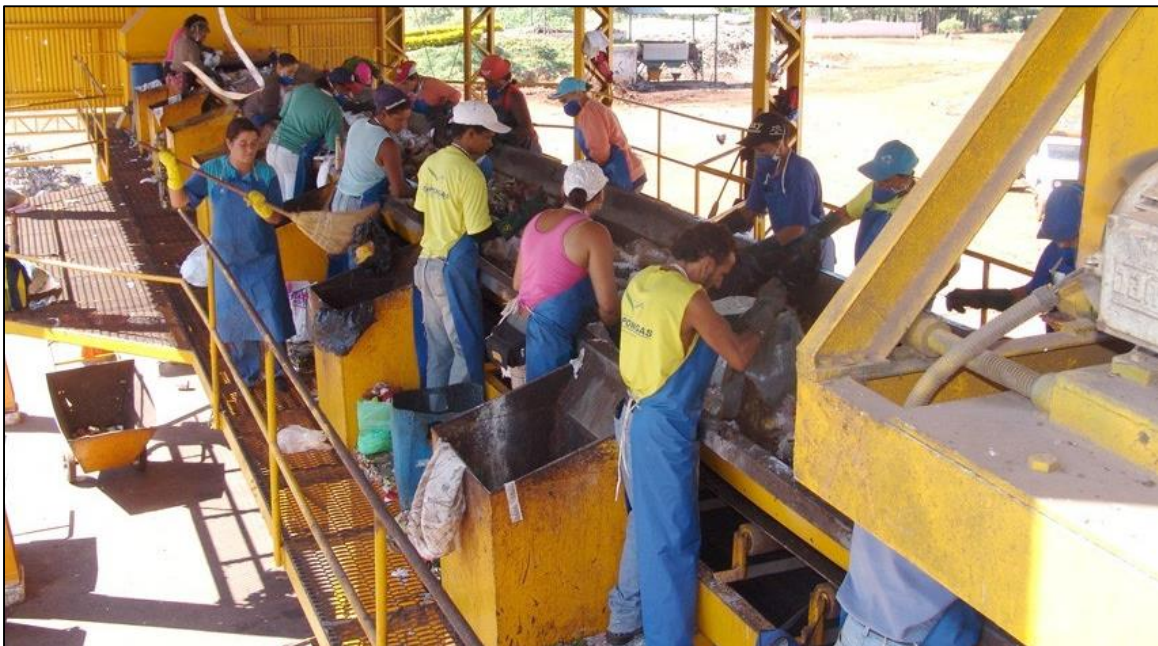
Triagem manual dos resíduos em esteira rolante
